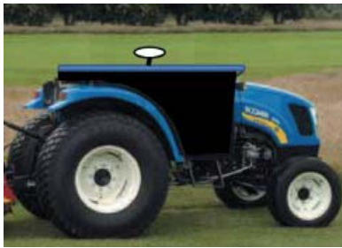
Vista schematica del trattore New Holland Broomer T3050 CVT privo di posto guida.
