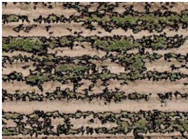
Imagen segmentada de varias líneas de maíz infestadas por malas hierbas obtenida de una unidad UAV
